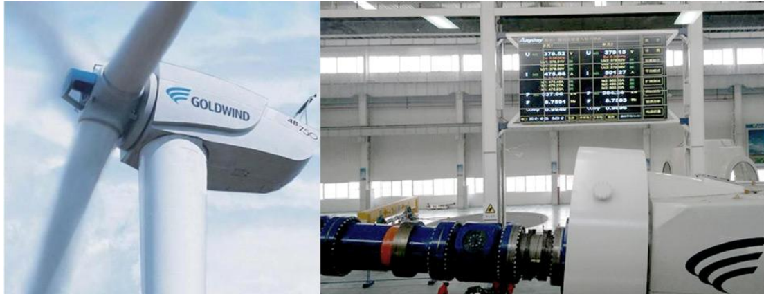
图8 金风科技永磁直驱风力发电机试验台
